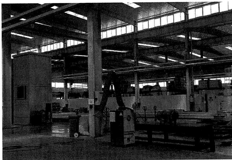
图 4-2 单臂早烟净化器治理装置现场照片
